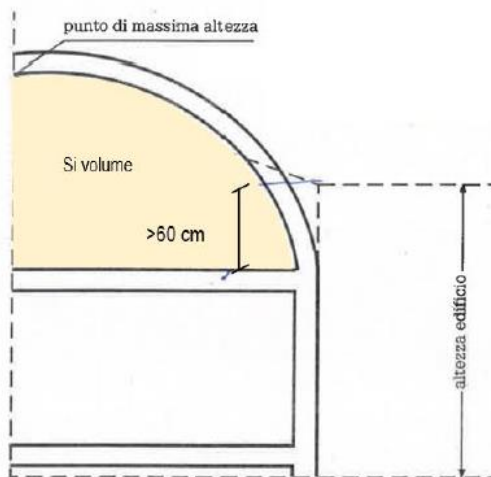
Fig. 12 Edificio con copertura ad andamento variabile con proiezione della pendenza superiore all'intradosso del solaio dell'ultimo piano abitabile
